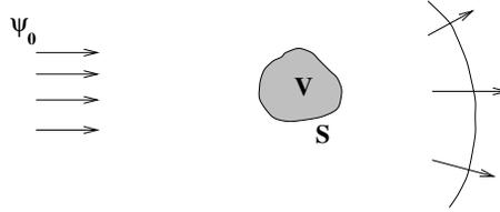
FIG. 1 – Représentation schématique de la diffusion d'une onde plane par un centre diffuseur.
