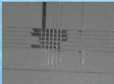
Résultats quadrillage sur métal après immersion dans l'eau DI pendant 14 jours. surface traitée (à gauche grade 0) et non traitée (à droite grade 3)
