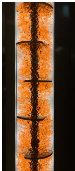
Colonne d'extraction pulsée, 5 cm de diamètre. JCP Gabriel, CEA Marcoule DES/ISEC/DMRC, Author provided (No reuse)
