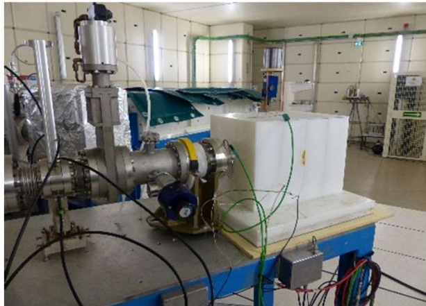
Accélérateur IPHI@Saclay: 3 MeV – 100 mA pic
