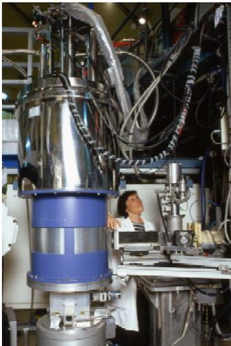
Le second aimant adapté à la diffusion aux petits angles est de type Oxford Spectromag SM4000 à bobines splittées. Il permet de générer des champs magnétiques horizontaux de 10 T orientés soit parallèlement, soit perpendiculairement au faisceau incident. Pour les mesures sur les cristaux, la hauteur et l'orientation de l'échantillon peuvent être réglées automatiquement in-situ.
