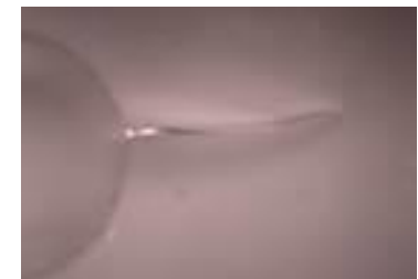
Image de la propagation d'une fissure sous-critique dans un verre d'oxyde
