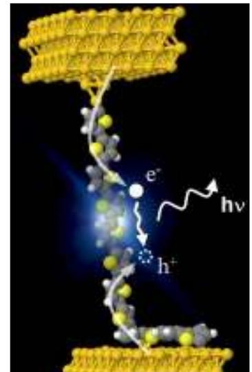
Electroluminescence d'un fil moléculaire suspendu dans une jonction STM.
