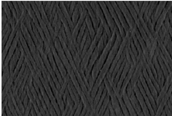
Réseau de fractures qui se forme spontanément dans une couche de matériau granulaire déposée sur une bande élastique étirée (les flèches indiquent le sens de la déformation. La distance typique entre fractures est de l'ordre du millimètre).
