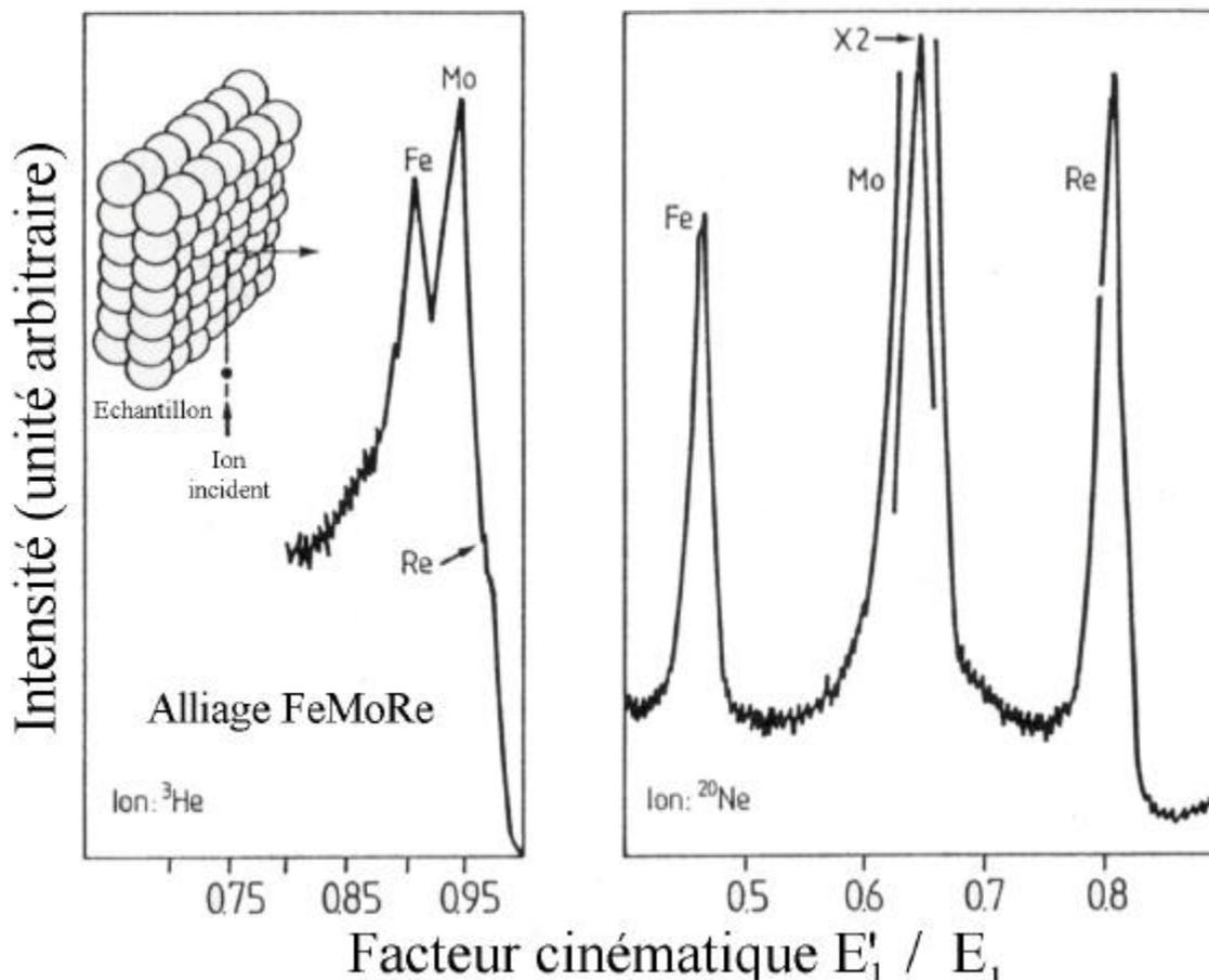
Alliage Fe/Mo/Re analysé par faisceaux d'ions  $^3\text{He}$  et  $^{20}\text{Ne}$  d'énergie  $E_1 = 1.5$  keV. J.T. McKinney, M. Leys 8<sup>th</sup> Nat. Conf. on Elec. Probe Anal., New Orleans, LA (1973).
