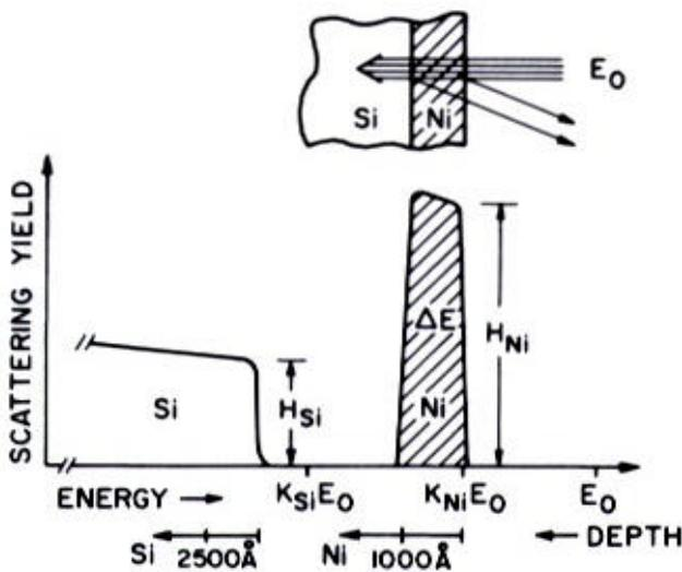
Spectre RBS ( ${}^4\text{He}^+$  2.0 MeV,  $\vartheta = 170^\circ$ ) d'un film de 1000 Å de  ${}^{58}\text{Ni}$  sur  ${}^{28}\text{Si}$
