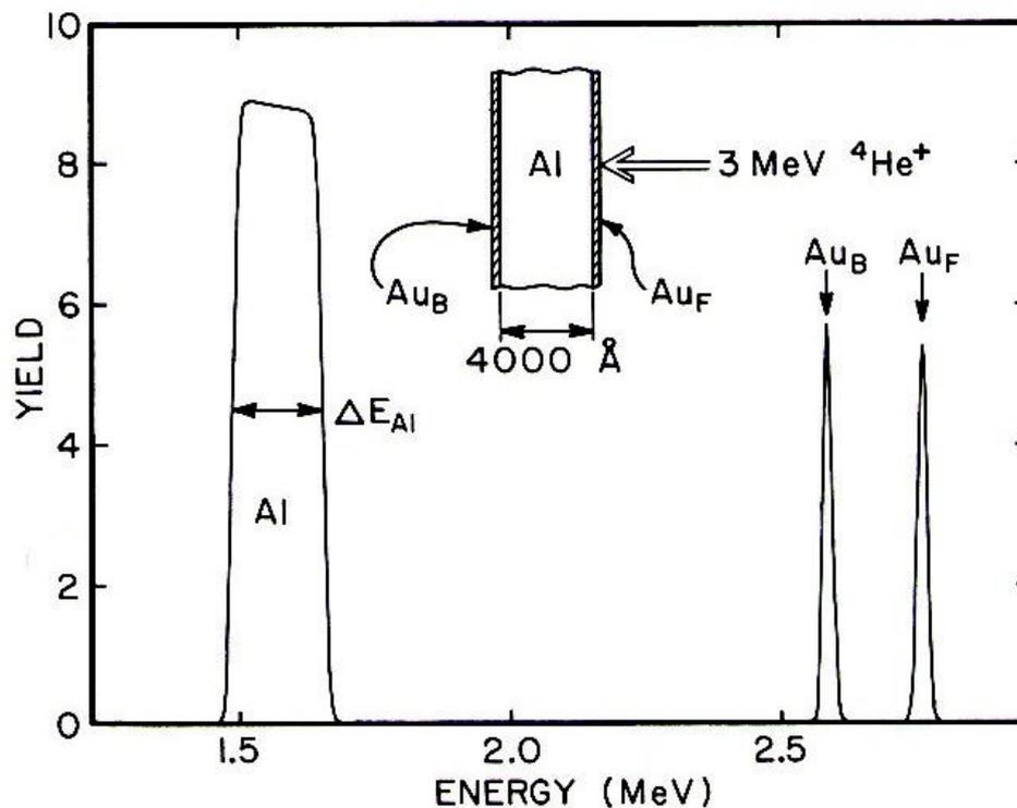
Spectre RBS ( $^4He^+$  3.0 MeV,  $\vartheta = 170^\circ$ ) d'un échantillon  $^{27}Al$  d'épaisseur 4000 Å recouvert de part et d'autre de 3 monocouches de  $^{197}Au$  :  $\left( \frac{dE}{dx} \right)_{He\ 3MeV} \approx 22 \text{ eV/Å}$ ,  $K_{Al} \approx 0.55$ ,  $\left( \frac{dE}{dx} \right)_{He\ 1.5\ MeV} \approx 29 \text{ eV/Å}$ ,  $K_{Au} \approx 0.92$  Feldman, J.W. Mayer dans *Fundamentals of Surface and Thin Films Analysis*, North Holland 1986.
