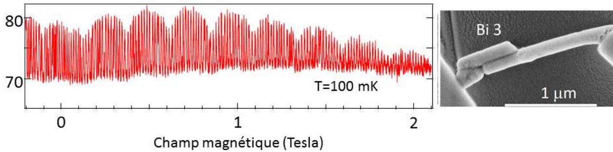
Oscillations du courant critique induit dans le nanofil de Bismuth contacté à deux électrodes en tungstène supraconducteur
