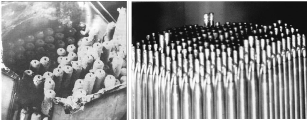
Figure 8 : Photographies d'assemblage du réacteur Phénix [10]. On peut observer l'allongement d'une partie des gaines.
