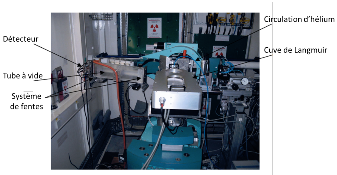
Figure 5.21: Photographie du montage expérimental utilisé dans nos expériences de diffusion-diffraction de rayons x en incidence rasante réalisées sur la ligne ID10B.
