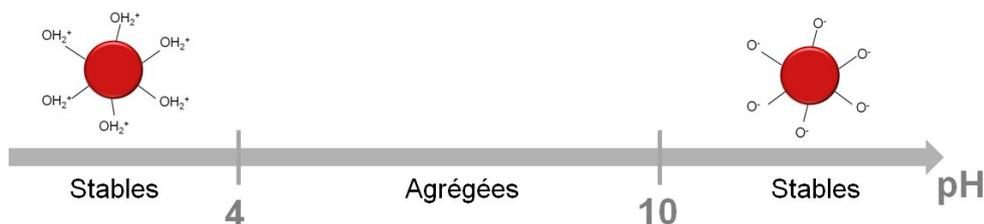
FIGURE 1.13 – Stabilité de suspensions de particules de maghémite en fonction du  $\text{pH}$ .
