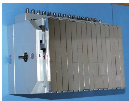
FIG. 2.3: Polarisation d'un faisceau de neutrons : a) Principe de la polarisation en spin d'un faisceau de neutrons : un faisceau de neutrons non polarisés (c'est-à-dire où la moitié des neutrons sont dans l'état de spin |+\rangle et l'autre moitié dans l'état |-\rangle ) interagit avec une structure ferromagnétique pour laquelle b_N = \gamma r_0 f_a(\mathbf{Q})M (où b_N = -\gamma r_0 f_a(\mathbf{Q})M ). Seuls les neutrons polarisés |+\rangle (ou |-\rangle ) sont diffusés b) Monochromateur double focalisant de Heusler constitué de 65 monocristaux de Heusler produits par l'ILL. c) Vue d'un bender formé de plusieurs dizaines de supermiroirs de CoFe/TiGd
