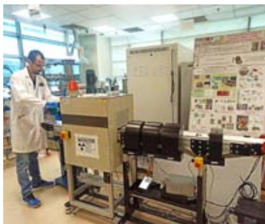
Banc de tri permettant de séparer les composants électroniques des circuits imprimés sur la base de leurs compositions chimiques. Cette technologie permet pour la première fois la concentration et donc le recyclage économiquement viable de métaux critiques. La recherche d'un partenaire de commercialisation est en cours.
