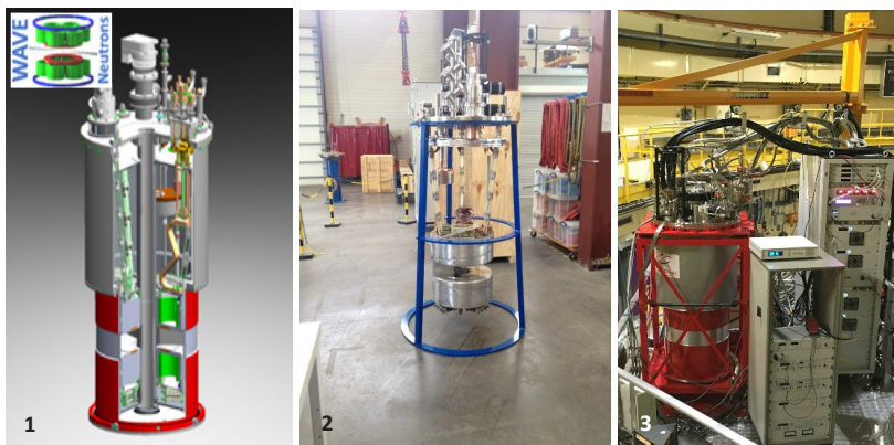
Figure 1 : Vue en coupe de Wave. En encart, le schéma de principe des bobines de champ par rapport au faisceau de neutrons. Figure 2 : L'insert de Wave à sa réception en usine chez Sigmaphi. Figure 3 : Wave en cours de test dans le hall du réacteur Orphée sur l'instrument 6T2 du LLB.
