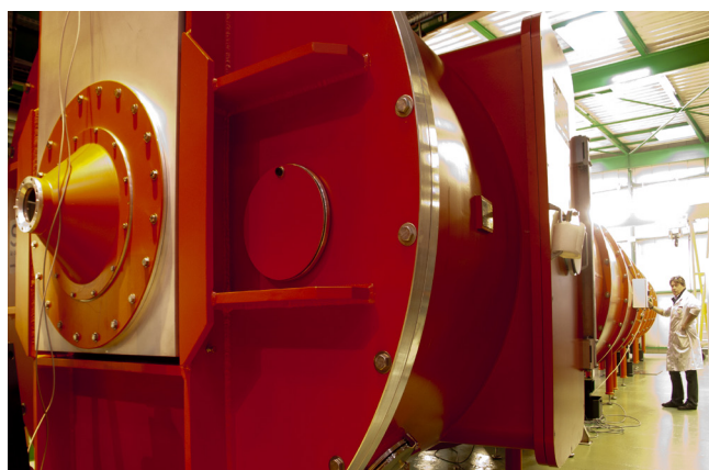
Le déplacement automatique des 2 détecteurs dans une enceinte à vide de 20 m de longueur, offre une flexibilité unique à l'appareil.
