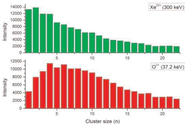
Distribution de taille des fragments  $H^+(H_2O)_n$  issus de la collision d'agrégats d'eau avec des ions multichargés lents,  $Xe^{20+}$  et  $O^{3+}$  respectivement. Les voies de fragmentation sont déterminées par des mesures en multi-coïncidence.
