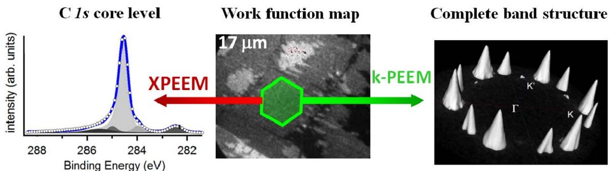
Carte 2D du travail de sortie d'un échantillon de graphène épitaxié sur SiC(00-1) (centre). Sur une zone spécifique il est possible d'imager d'une part l'espace direct et d'obtenir des informations chimiques (gauche) ou l'espace réciproque, et ainsi d'acquérir la structure de bande complète (droite).
