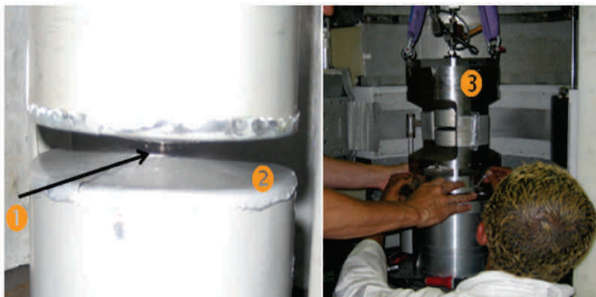
FIGURE 2.19 – Presse Paris Edimbourg utilisée lors de l'expérience sur D20; (1) joint Ti-Zr; (2) Enclumes (c-BN) avec protections en cadmium; (3) Presse Paris Edimbourg
