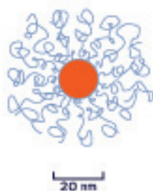
Cheveux de polymères greffés sur une bille de silice (des couleurs différentes symbolisent des "densités de diffusion" différentes).
