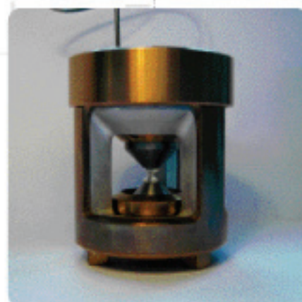
Cellule pour mesure sous très haute pression
