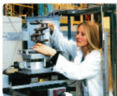
Analyse des contraintes dans une roue de wagon après 1 400 000 Km de fonctionnement
