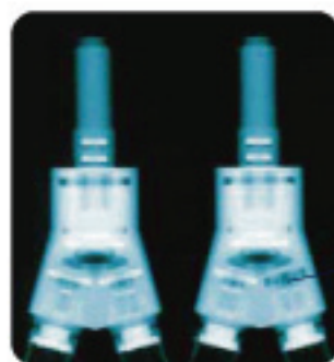
Radiographie neutrons de vérins pyrotechniques ARIANE; il manque un joint caoutchouc
