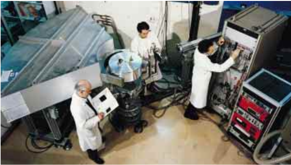
Le diffractomètre « poudre » G41 et son multidétecteur 800 cellules
