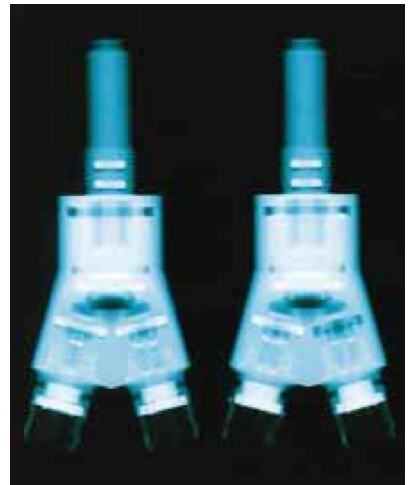
Radiographie aux neutrons de vérins pyrotechniques ARIANE (DASSAULT-AVIATION).
