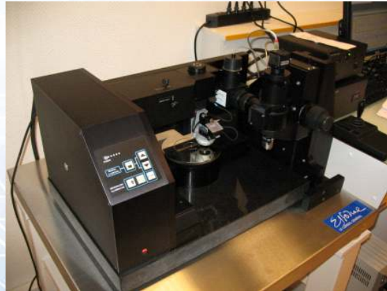
Un nouvel instrument pour l'étude multi-échelles des films nanométriques obtenu par couplage d'un AFM et d'une microscopie « SARFUS »
