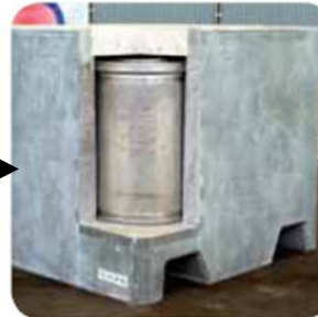
Conteneur de stockage MA-VL
