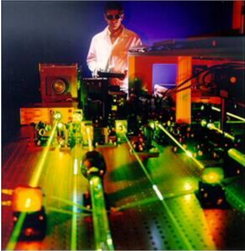
Etages amplificateurs du laser UHI (Ultra-Haute Intensité) à Saclay
