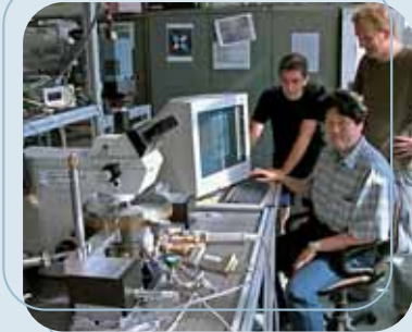
Expérience de "magnéto-optique très basse température" (< 1,5 K) pour la visualisation du flux magnétique
