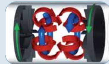
Principe d'un écoulement turbulent de sodium liquide entre 2 turbines tournant en sens contraire. (Image SPEC)
